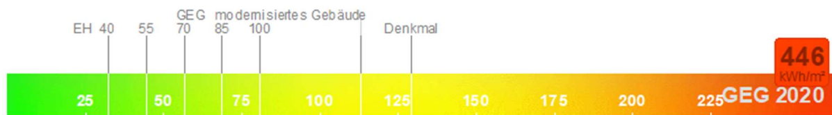
Abbildung 18 | Primärenergiebedarf des Mehrfamilienhauses um 1960
